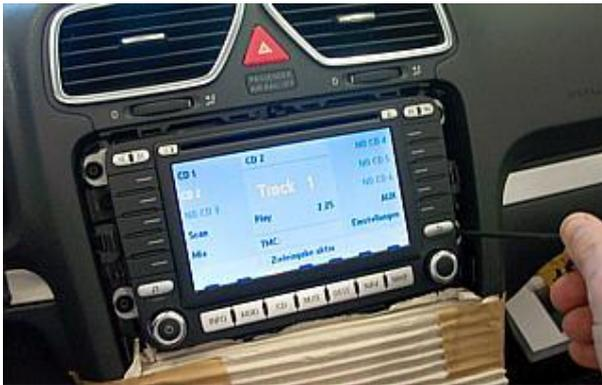
Klima-Bedienelemente abkleben, um Beschädigungen zu vermeiden. Dann die vier Schrauben des Steuergeräts mit Torx® T20 lösen.
