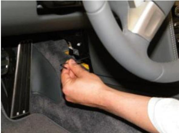
Schraube der Seitenblende lösen.
