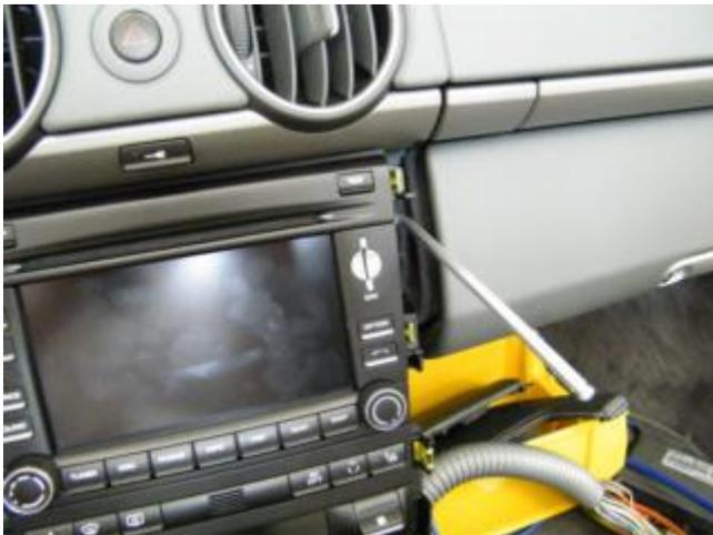
Vier seitliche Schrauben lösen und Navigationsgerät ausbauen.
