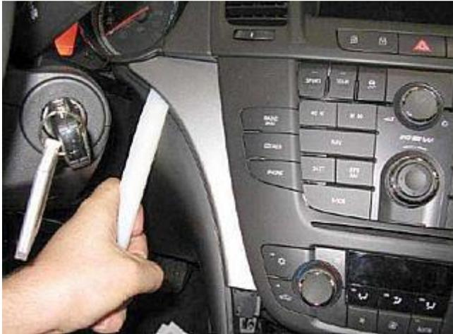
Linke Blende mit einem flachen, breiten Werkzeug entfernen.
