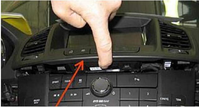
Display-Blende leicht nach oben herauskippen und anschließend das Radiobedienteil nach vorne kippen. Zum Entnehmen des Radiobedienteils die Stecker abziehen.
