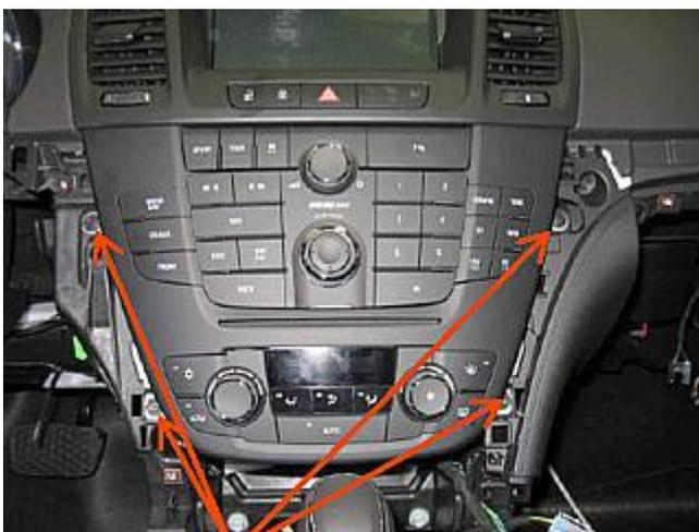
Die vier Schrauben des Radiobedienteils lösen.
