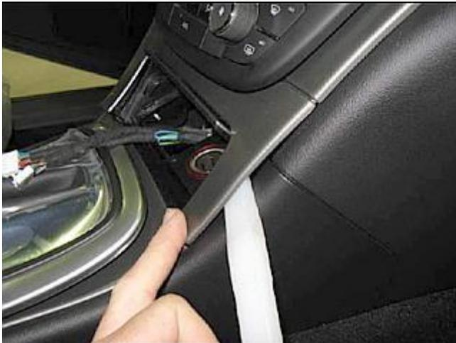
Aschenbecherdeckel ausbauen und Blende mit einem flachen, breiten Werkzeug abhebeln. Die Blende kann anschließend nach unten abgezogen werden.
