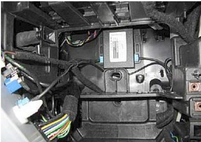
ImageHub mit ImageCutter über RJ-45-Kabel verbinden. Anschließend ImageHub z.B. mit Klettband anbringen und System in umgekehrter Reihenfolge wieder zusammenfügen.
