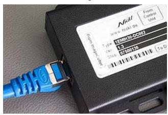
Das RJ45-Kabel (1EZKA-2xRJ45S-x-x) wird in den ImageHub bei "From ImageCutter" eingesteckt.
