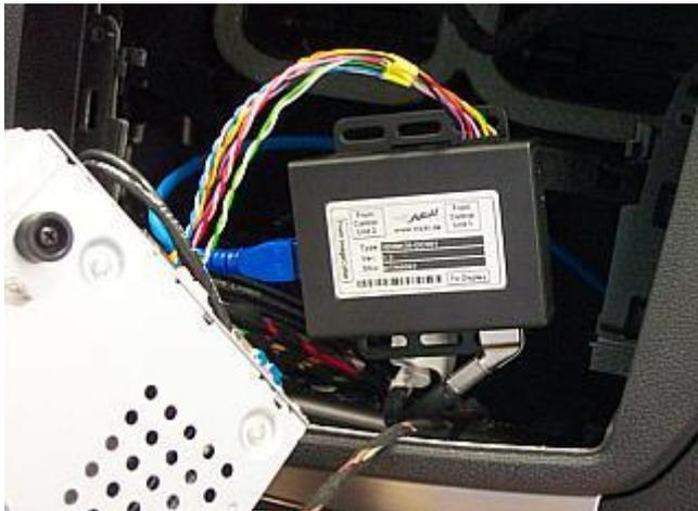
Führen Sie das RJ-45-Kabel z.B. vom Handschuhfach aus in den Bereich unter dem Steuergerät.
