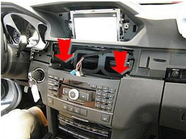
Entfernen Sie die beiden Schrauben des Steuergeräts. Ziehen Sie anschließend das Steuergerät nach vorne heraus.
