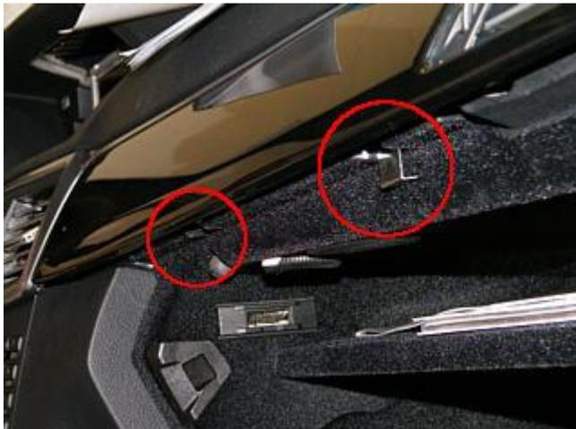
Entriegeln Sie die beiden Blechklammern bei geöffnetem Handschuhfach, indem Sie sie mit einem Haken herunterziehen. Anschließend kann die Blende mit den Lüftungsauslässen abgezogen werden.
