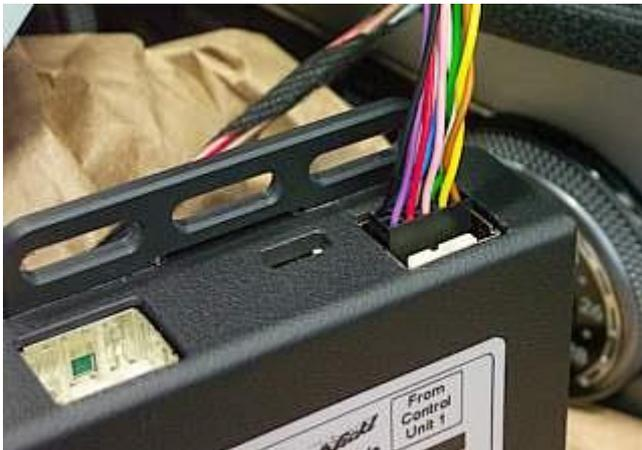
Stecken Sie das andere Ende des Kabels in den ImageHub an der Stelle mit der Beschriftung "From Control Unit 1". Die Kodiernase muss zum Montageflansch des ImageHubs zeigen.
