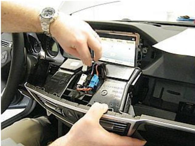
Jetzt lässt sich die Lüftungsdüsen-Einheit nach vorne herausziehen. Stecken Sie nun die Kabel ab und entfernen Sie die Lüftungsdüsen-Einheit.
