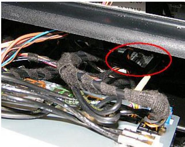
Legen Sie nun den ImageHub auf ein Stück dünnen Schaumstoff an die gezeigte Stelle auf das Airbag-Steuergerät. Anschließend wird ein Stück Schaumstoff auf den ImageHub gelegt und das Steuergerät wieder eingeschoben.
