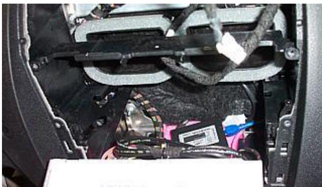
Legen Sie nun den ImageHub auf ein Stück dünnen Schaumstoff an die gezeigte Stelle. Anschließend wird ein Stück Schaumstoff auf den ImageHub gelegt und das Steuergerät wieder eingeschoben.
