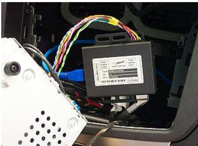
Führen Sie das RJ-45-Kabel z.B. vom Handschuhfach in den Bereich hinter dem Steuergerät.
