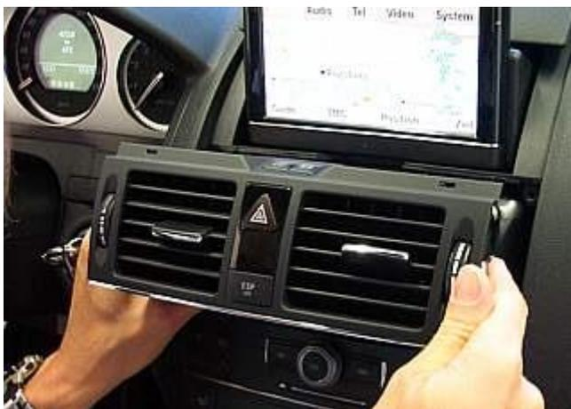
Jetzt lässt sich die Lüftungsdüsen-Einheit nach vorne herausziehen. Stecken Sie nun die Kabel ab und entfernen Sie die Lüftungsdüsen-Einheit.
