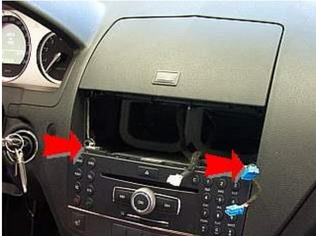
Lösen Sie die Schrauben des Steuergeräts und schieben die Riegel hinter den Schrauben nach oben (siehe Bild unten). Ziehen Sie anschließend das Steuergerät nach vorne heraus.
