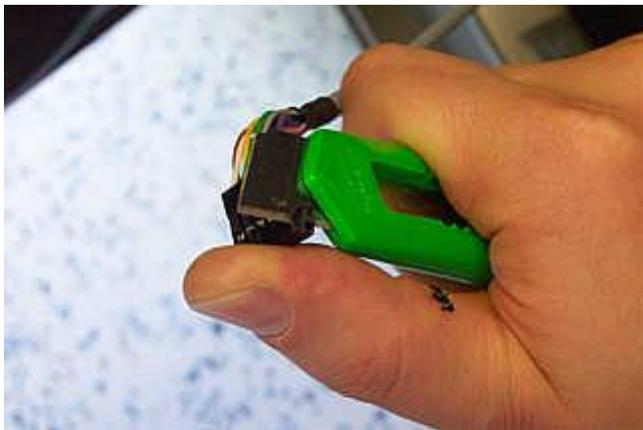
Die breite Seite des grauen 1:1-Kabels muss um die nicht-belegten Kontaktpositionen gekürzt werden. Eventuell muss die Kodiernase auch gestutzt werden. Dazu Seitenschneider oder scharfes Messer verwenden.
