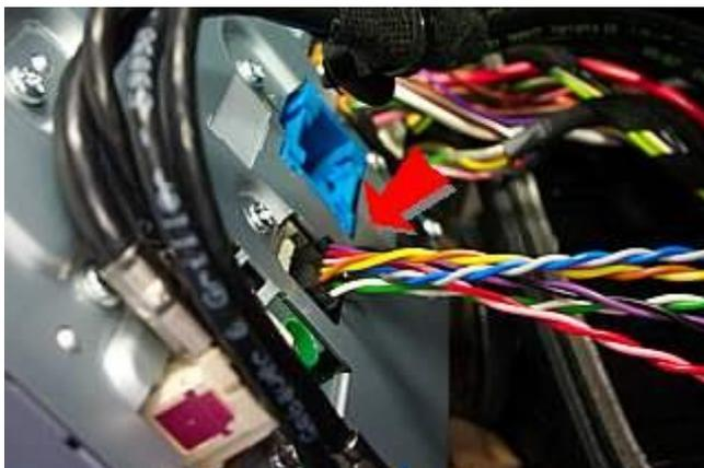
Ziehen Sie das Original-LVDS-Kabel und stecken Sie das neue Kabel mit der Kodiernase nach unten zeigend ein (siehe roter Pfeil).
