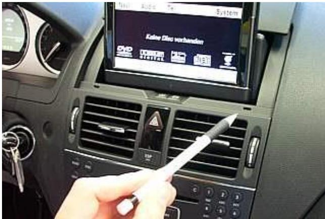
Das Display muss ausgefahren werden. Entriegeln Sie die Lüftungsdüsen-Einheit, indem Sie in die zwei kleinen Schlitze einen flachen Gegenstand ca. 15mm einschieben und nach oben kippen, so dass die innen liegenden Rastnasen nach unten gedrückt werden.
