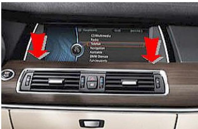
Zwei Schrauben (Torx 20) unterhalb des Bordmonitors lösen und Bordmonitor herausnehmen
