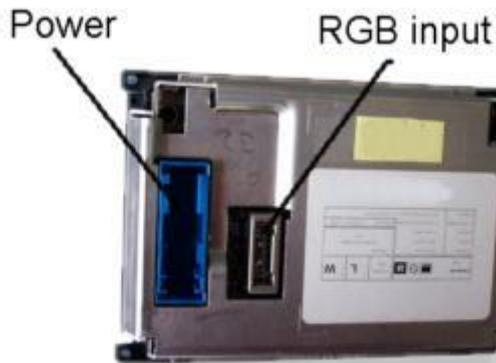
Die Display-Einheit hat an der Rückseite den Power-Stecker (über den noch weitere Signale geführt sind) sowie den RGB-Eingang.
