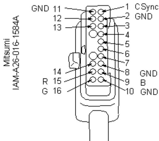
Das Bild zeigt die Anschlussbelegung des Steckers für den RGB-Eingang. Zwischen ImageHub30-ANA001 und der Display-Einheit wird ein Kabel mit folgender Belegung benötigt.
