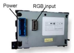
Die Display-Einheit hat an der Rückseite den Power-Stecker (über den noch weitere Signale geführt sind) sowie den RGB-Eingang.
