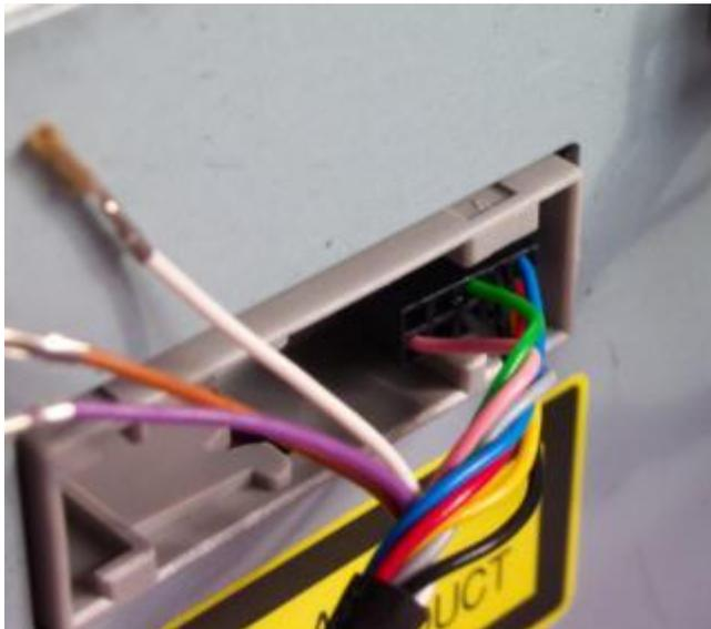
Das obig modifizierte Kabel mit dem kleinen Stecker ins Steuergerät stecken. Dabei die Nase nach oben und die Kontakte rechtsbündig ausrichten. Der große Stecker wird in den ImageHub an der Stelle "To Display" eingesteckt.
