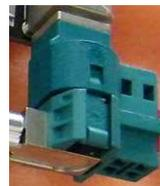
Das noch freie Ende des **1EZKA-RB4ZsRB4Zs-1.5** Kabels an der IH120-POR003 Buchse „Control Unit“ anstecken.
